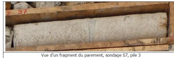
Vue d'un fragment du parement, sondage S7, pile 3
